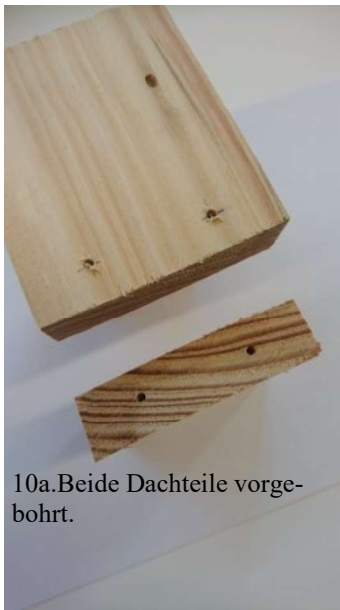
10b. Mit kleinerem Durchmesser als die Schraube, um Spalten zu verhindern
