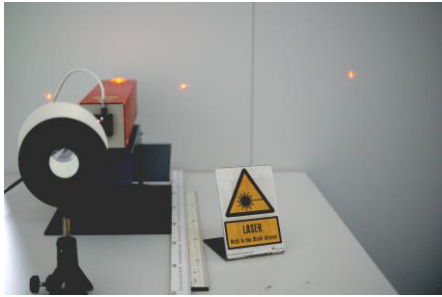
Abb. 3: Demonstrationsversuch zur CD als Reflexionsgitter
