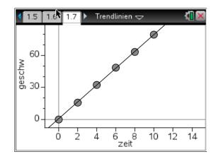
Die Zuordnung "Zeit → Geschwindigkeit" ist abschnittweise linear. Das Motorrad startet aus der Ruhelage. In jeder Sekunde nimmt die Geschwindigkeit um etwa 8 m/s zu, von der 11. bis zur 15. Sekunde bleibt die Geschwindigkeit konstant bei 80 m/s.
