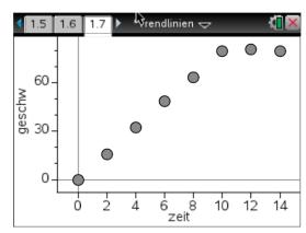
Die graphische Darstellung der Zuordnung "Zeit → Geschwindigkeit" zeigt, dass bis zur zehnten Sekunde die Geschwindigkeit wächst (Beschleunigungsphase), danach indes konstant bleibt. Dies hat zur Folge, dass man in der Datentabelle alle Werte für die Zeit t = 11, 12, 13, 14 löschen muss, damit der GTR treffende Ausgleichskurven ermitteln kann. (Hat man die Kurven zuvor ermittelt und löscht danach die Daten, so passt der GTR i.d.R. automatisch die bereits gemachten Berechnungen an.)
