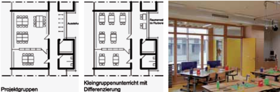
Nutzungsvarianten eines sogenannten Heimatbereichs mit Unterrichts- und Differenzierungsraum, Garderobe und WC in der Grundschule Niederheide, Hohen Neuendorf
