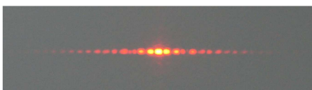
Abb. 2: Interferenzmuster eines Doppelspalts mit d = 0,2 \text{ mm} .
