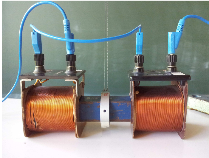
Abbildung 5a: Zwei Feldspulen hintereinander geschaltet, entweder liegt N-Pol gegenüber N-Pol oder S-Pol gegenüber S-Pol
