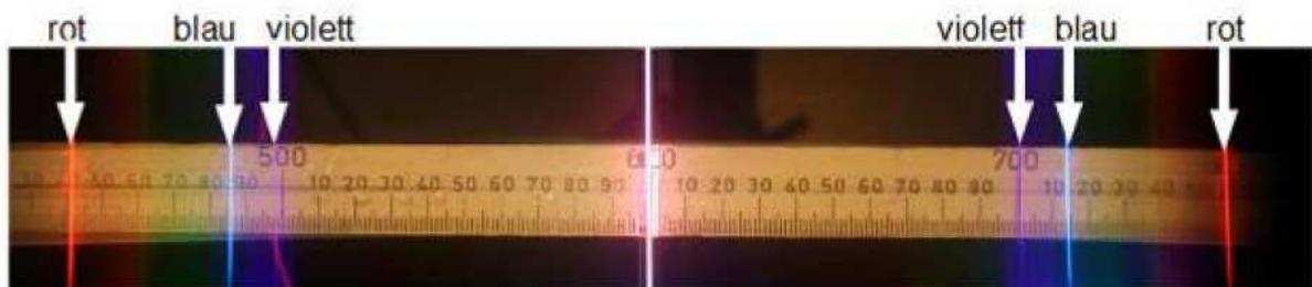
Abbildung 2 Wasserstoffspektrum durch das Gitter beobachtet
