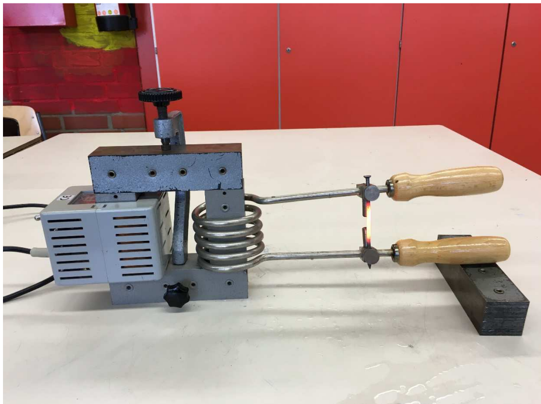
Abbildung 7 Experimenteller Aufbau zu "Hochstromtransformation"
