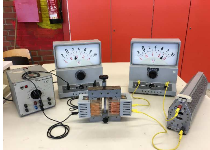
Abbildung 5 Experimenteller Aufbau zur Stromtransformation
