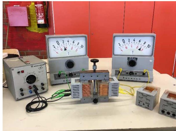
Abbildung 2 Experimenteller Aufbau zur Spannungstransformation
